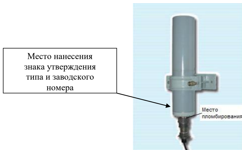
Рисунок 1 - Общий вид блока детектирования БДМГ-300
