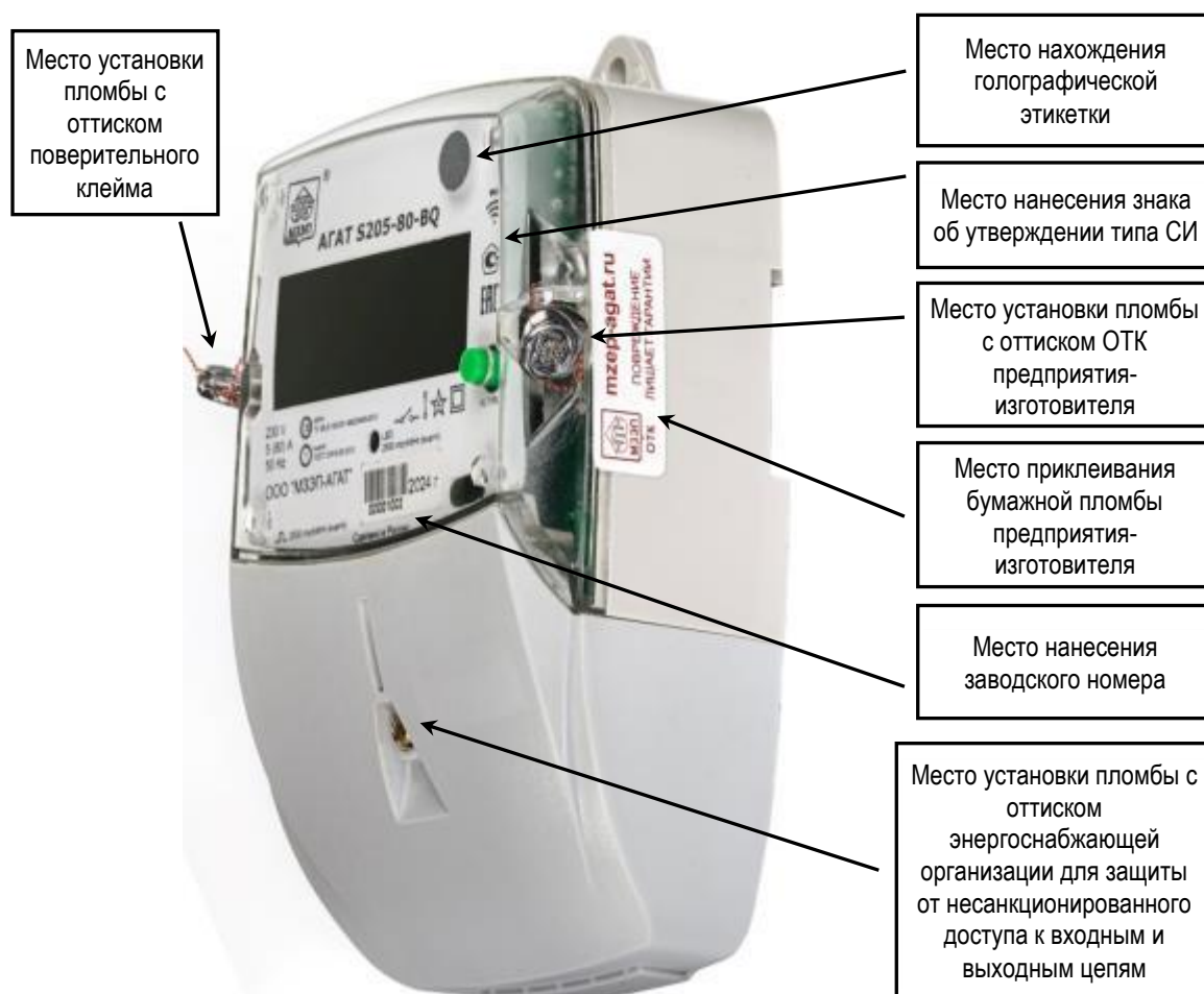
Рисунок 2 – Общий вид счетчика типа АГАТ S200 с указанием мест установки пломб, нахождения голографической этикетки, нанесения заводского номера и знака утверждения типа СИ
