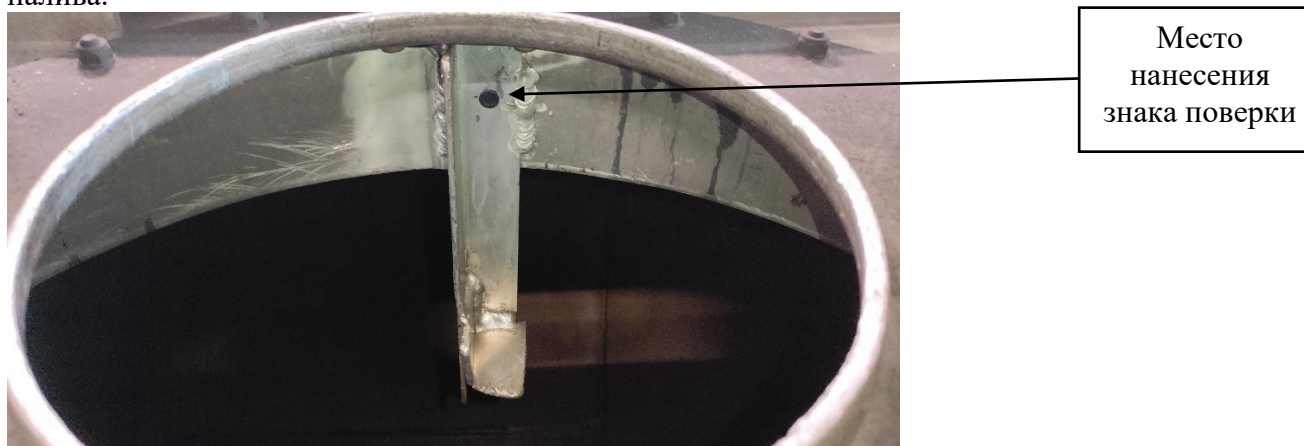
Рисунок 3 – Схема пломбировки от несанкционированного изменения положения указателя уровня налива, обозначение места нанесения знака поверки
