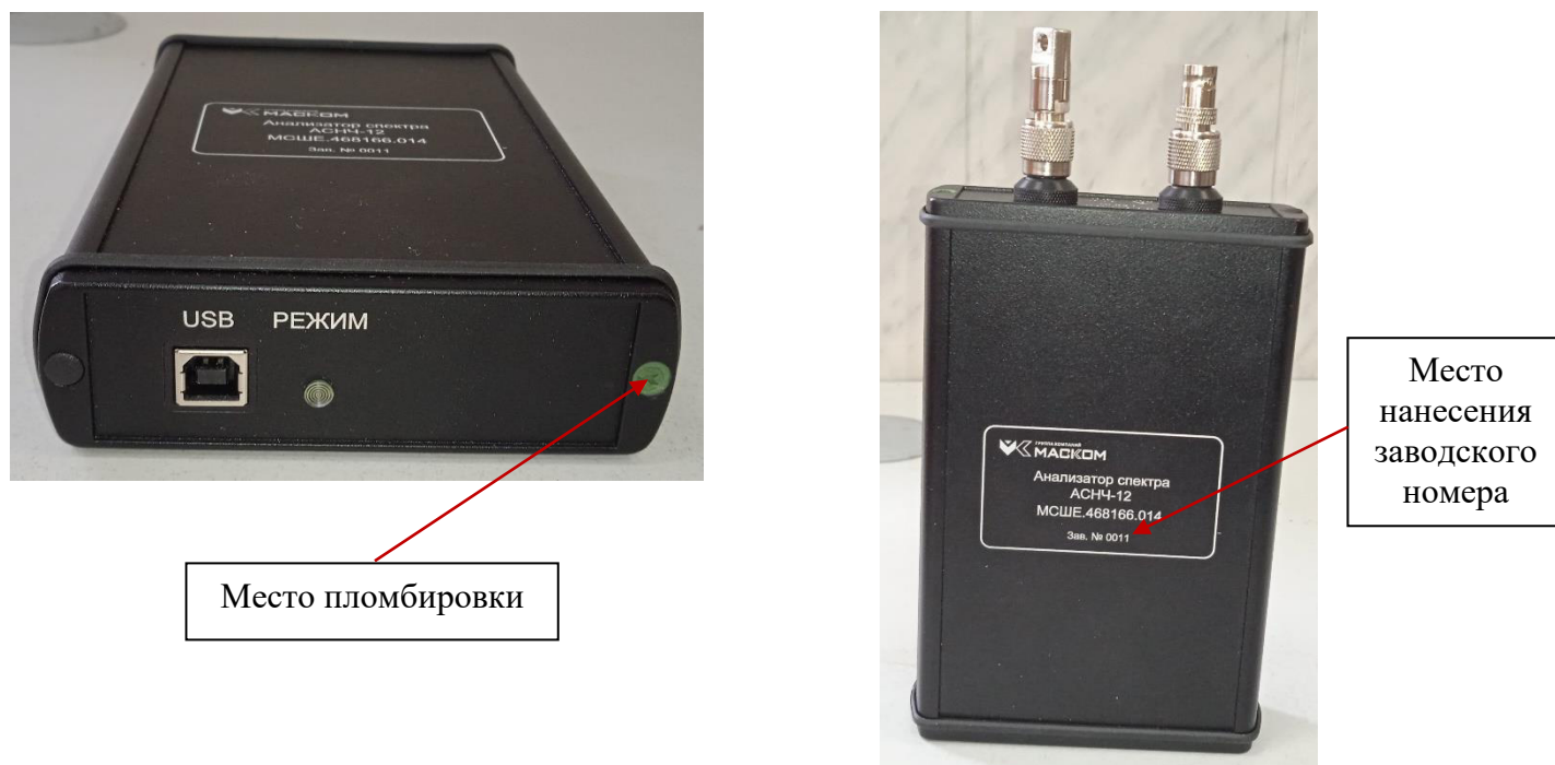
Рисунок 2 – Общий вид анализаторов спектра АСНЧ-12 с указанием мест пломбировки, нанесения заводского номера
