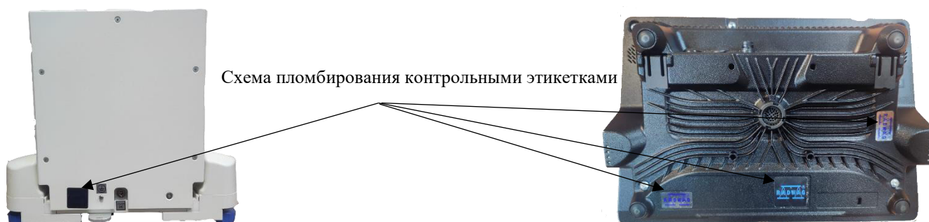
Рисунок 7 – Схема пломбирования от несанкционированного доступа
