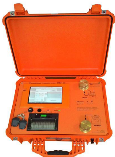
Рисунок 1 – Общий вид установок поверочных СПУ-3М со встроенным показывающим и управляющим устройством и встроенным принтером
