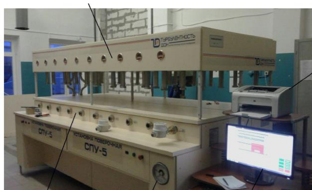
Рисунок 4 - СПУ-5-Х-3 Установка с тридцатью одновременно подключаемыми счетчиками
