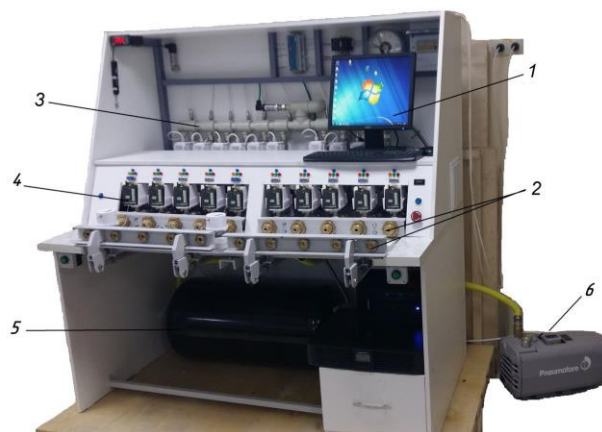
Рисунок 2 - СПУ-5-Х-1 Установка с десятью одновременно подключаемыми счетчиками
