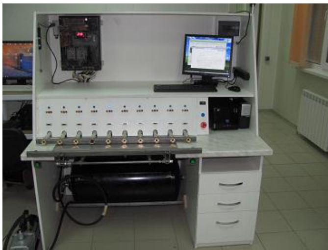
Рисунок 1 - СПУ-5-Х-1 Установка с десятью одновременно подключаемыми счетчиками
