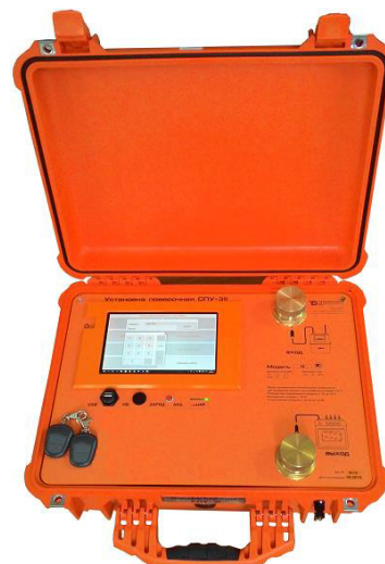
Рисунок 2 – Общий вид установок поверочных СПУ-3М со встроенным показывающим и управляющим устройством без принтера
