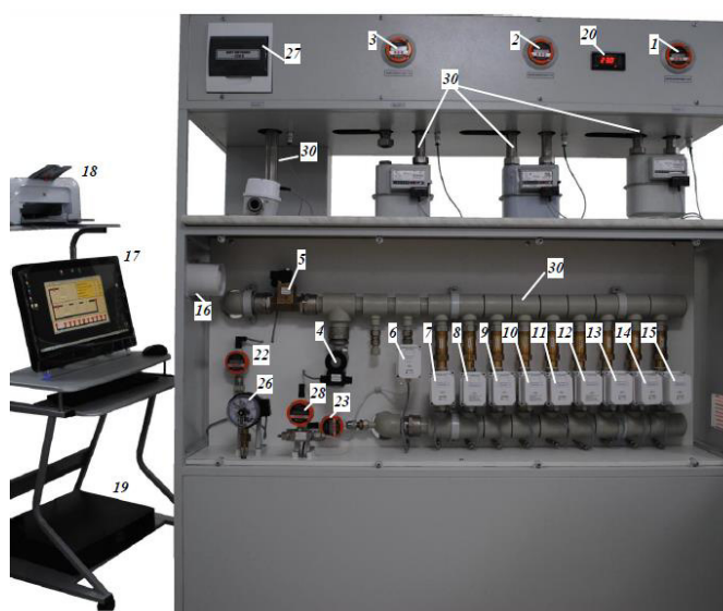
Рисунок 3 - СПУ-5-Х-3 Установка с четырьмя одновременно подключаемыми счетчиками
