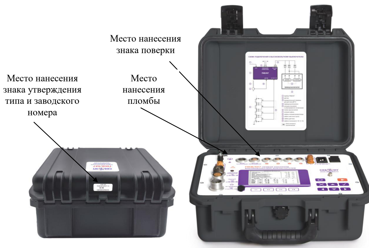
Рисунок 1 – Общий вид средства измерений
