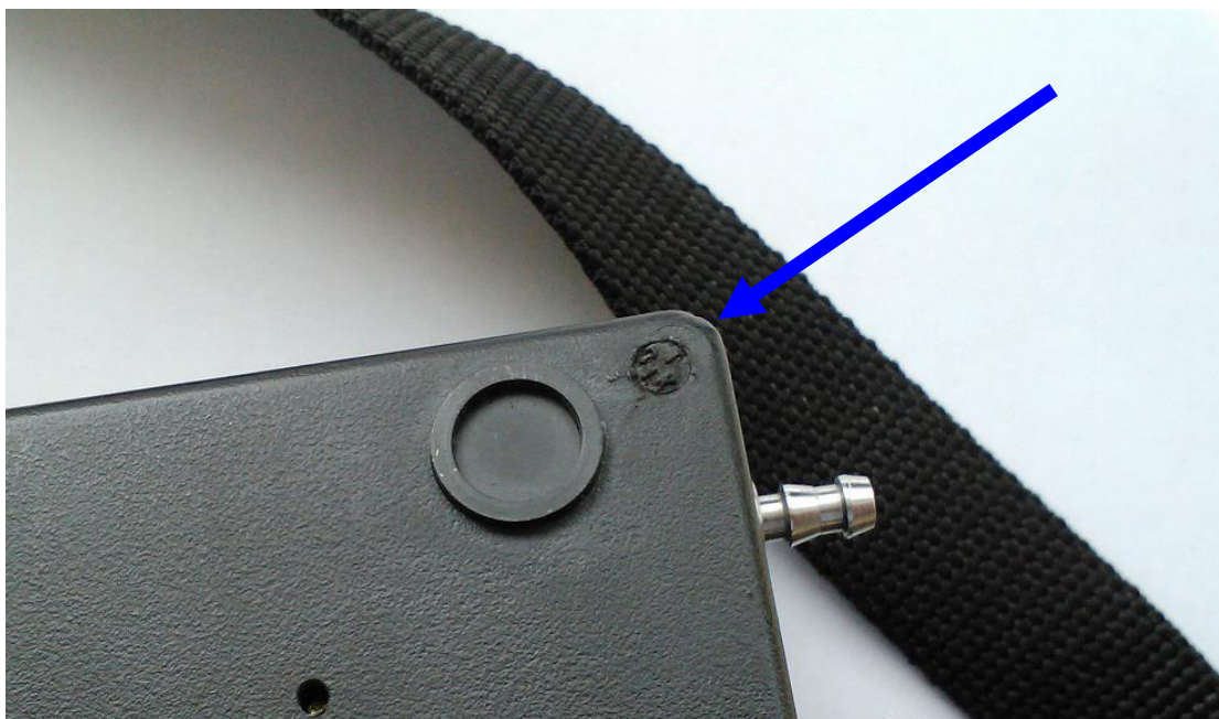
Рисунок 2 - Место нанесения знака поверки в виде отиска поверительного клейма на задней стенке прибора.
