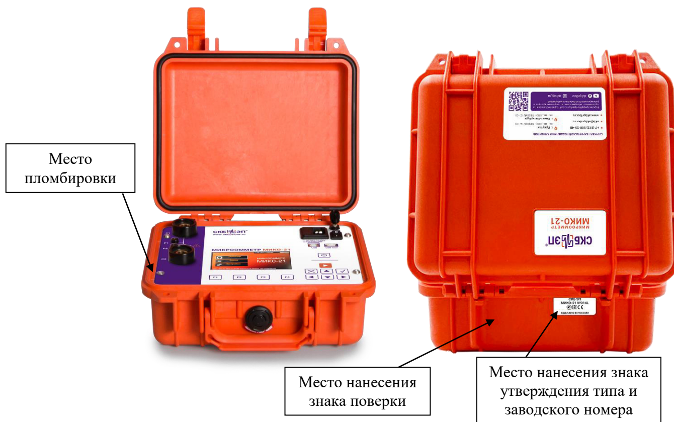
Рисунок 1 – Общий вид микроомметров МИКО-21 с указанием места пломбировки, мест нанесения знака утверждения типа, знака поверки и заводского номера
