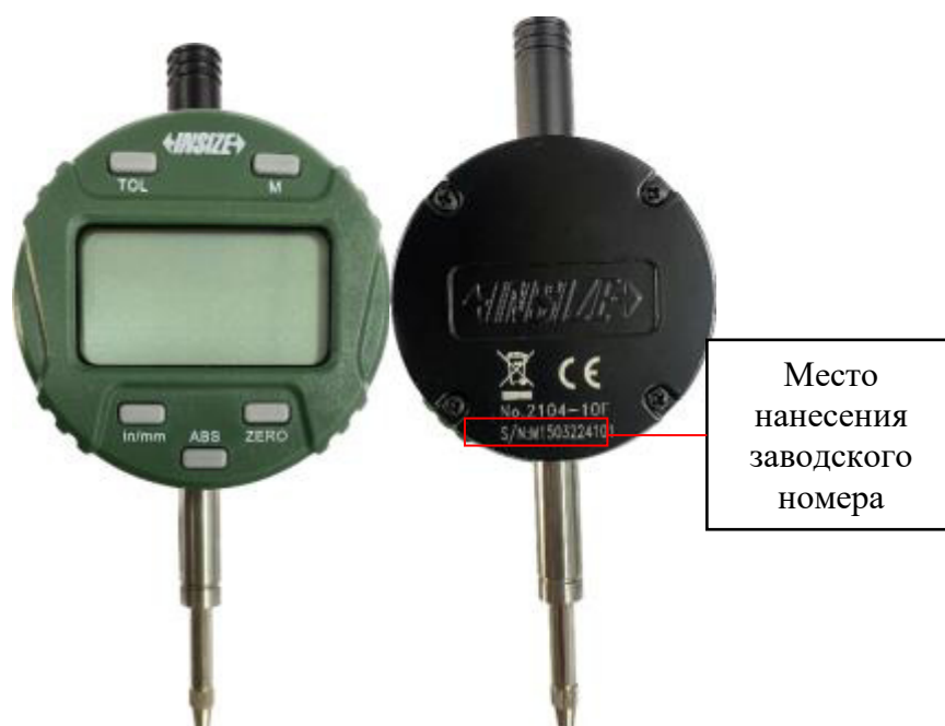
Рисунок 18 – Общий вид отсчетного устройства модификации 2104-10F с указанием места нанесения заводского номера
