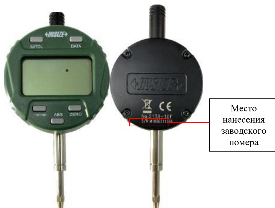
Рисунок 14 – Общий вид отсчетного устройства модификации 2138-10F с указанием места нанесения заводского номера
