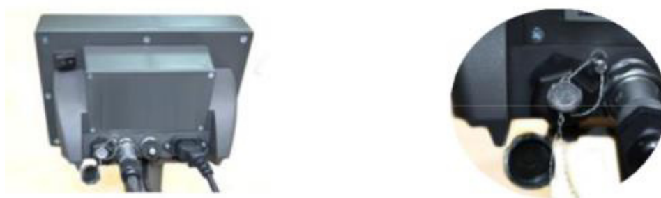
Рисунок 10 – Схемы пломбировки терминалов ТИТАН 3Ц
