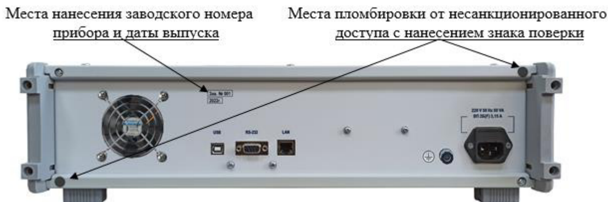
Рисунок 2 – Схема пломбировки от несанкционированного доступа с нанесением знака поверки, обозначение мест нанесения заводского номера и даты выпуска
