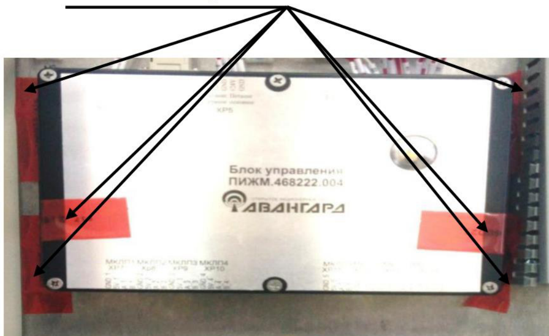
Рисунок 4 – Пломбировка БУ (вид сверху)
