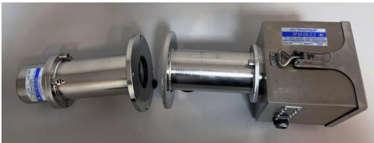
Рисунок 2 – Общий вид пылеизмерителей модификации ЛПИ-05.2.2 (блоки приёмопередатчика и отражателя с диффузорами)
