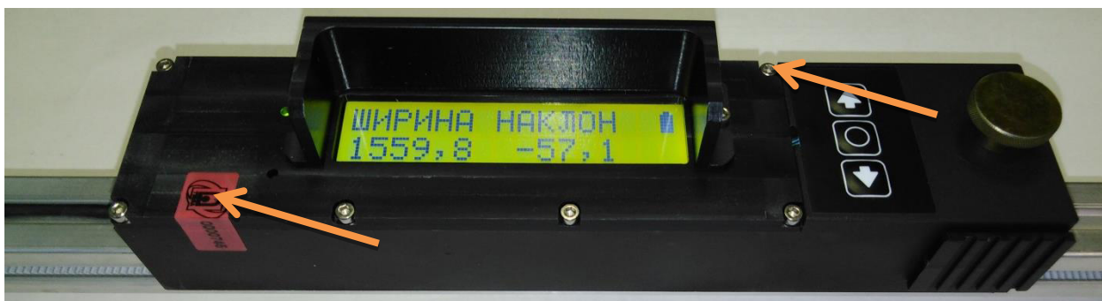
Рисунок 4 – Места пломбирования ШЭП (указаны стрелками)
