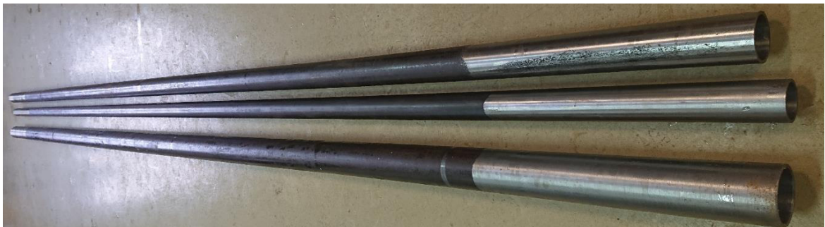
Рисунок 1 – Общий вид мер с искусственными дефектами 452.008
