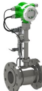
Рисунок 5 – Расходомеры-счетчики вихревые «ЭМИС-ВИХРЬ 200» модификации ЭВ-200 с установленными на корпусе расходомера датчиками давления и/или температуры (а. исполнение с внешним датчиком давления и внешним термопреобразователем, смонтированными на корпус расходомера; б. исполнение с внешним датчиком давления и встроенным термопреобразователем)
