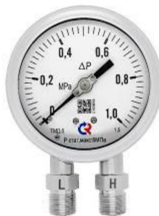
Рисунок 5 – Манометр показывающий дифференциальный модификации 5
