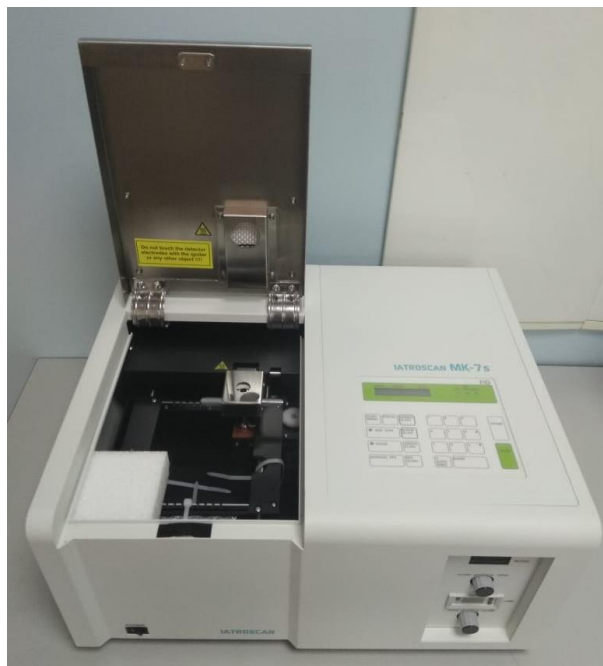
Рисунок 1 – Общий вид анализатора хроматографического IATROSCAN MK-7s
