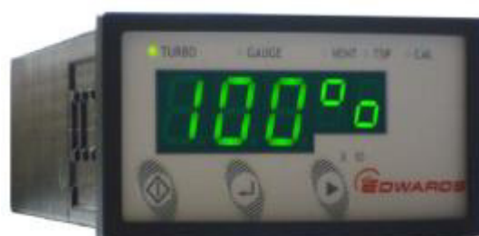
Рисунок 3 – Общий вид контроллера TAG
