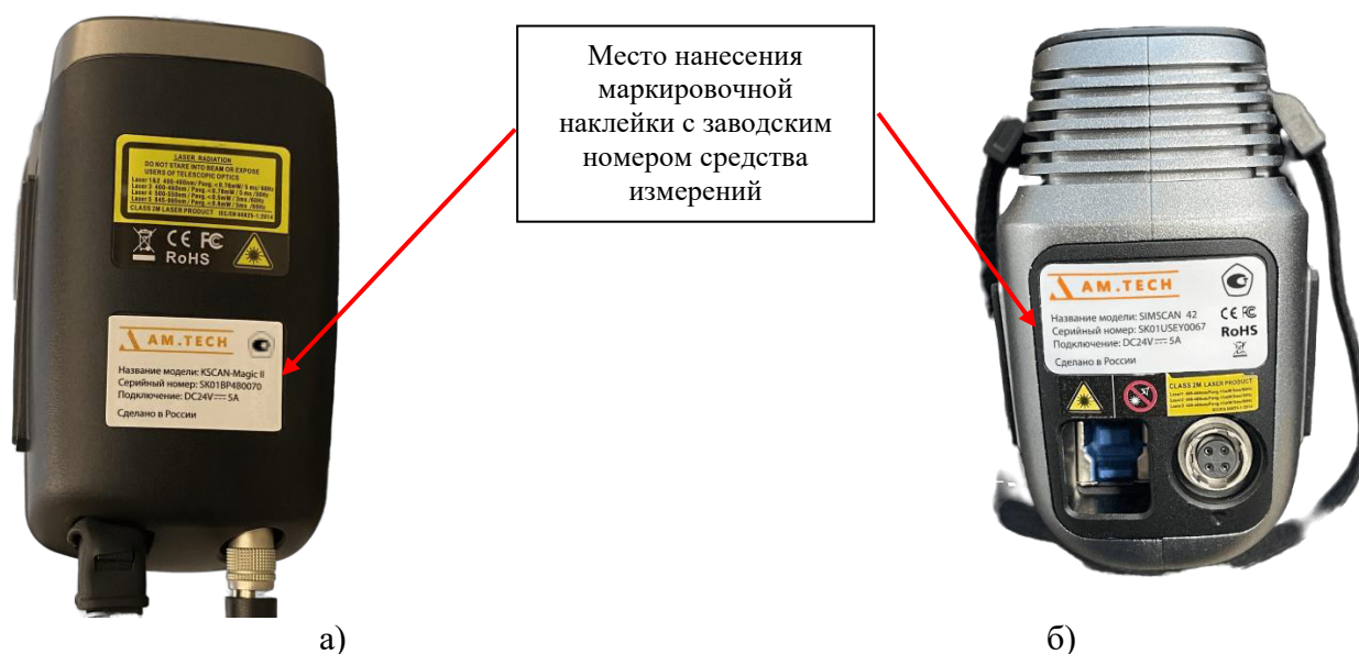
Рисунок 3 - Место расположения маркировочных наклеек с указанием заводского номера приборов оптических координатно-измерительных бесконтактных AM.TECH LaserSCAN модификаций: а) AM.TECH LaserSCAN KSCAN MAGIC, AM.TECH LaserSCAN KSCAN MAGIC II, AM.TECH LaserSCAN AXE B11, AM.TECH LaserSCAN AXE B17; б) AM.TECH LaserSCAN SIMSCAN 22, AM.TECH LaserSCAN SIMSCAN 30, AM.TECH LaserSCAN SIMSCAN 42
