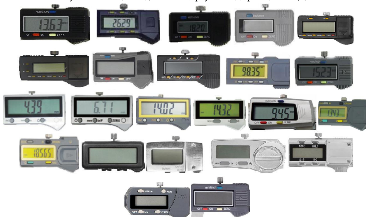
Рисунок 8 – Варианты исполнения цифрового отсчётного устройства для штангенциркулей модификации ШЦЦ-I, ШЦЦ-II, ШЦЦ-III
