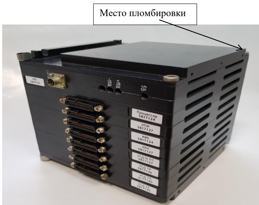
ж) Общий вид узлов установленных в модуль
