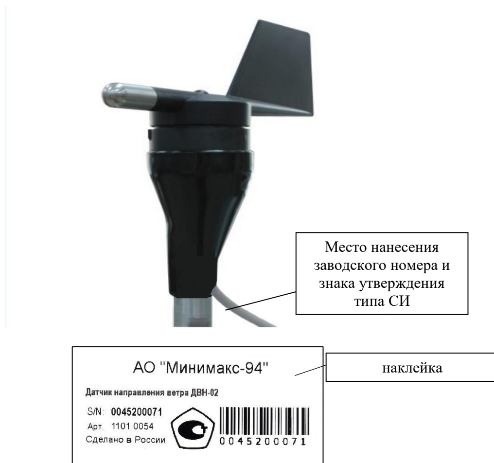
Рисунок 1 – Общий вид датчиков направления ветра ДВН-02 с указанием места нанесения заводского номера и знака утверждения типа СИ
