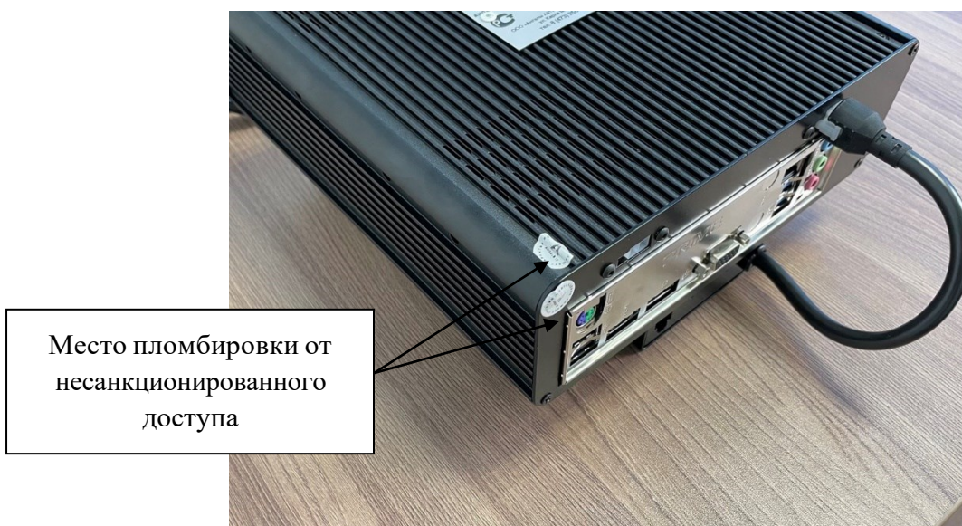
Рисунок 2 – Схема пломбировки комплексов исполнения 01 от несанкционированного доступа
