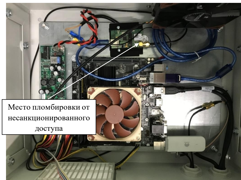
Рисунок 5 – Схема пломбировки от несанкционированного доступа комплексов исполнения 03
