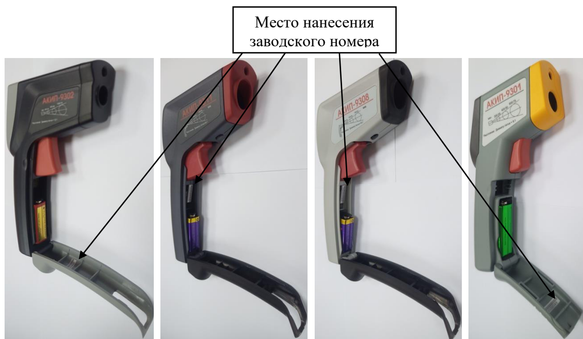
Рисунок 2 – Общий вид пирометров с указанием мест нанесения заводского номера
