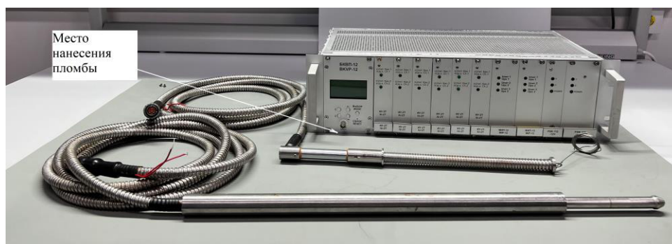
Рисунок 1–Общий вид измерителей линейных перемещений многоканальных
