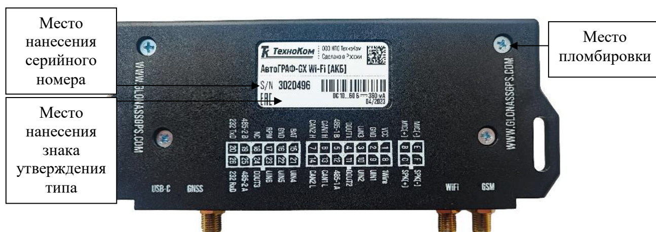
Рисунок 9 – Общий вид контроллеров модификации АвтоГРАФ-GX, исполнения: АвтоГРАФ-GX Wi-Fi, АвтоГРАФ-GX Wi-Fi [АКБ] (лицевая сторона)
