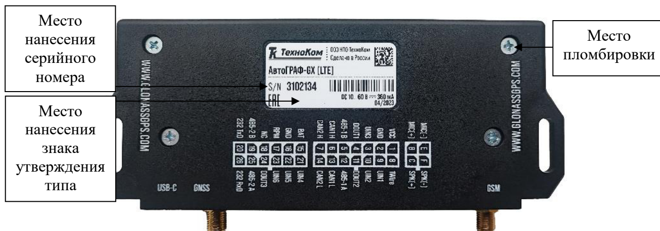
Рисунок 8 – Общий вид контроллеров модификации АвтоГРАФ-GX, исполнения: АвтоГРАФ-GX, АвтоГРАФ-GX [АКБ], АвтоГРАФ-GX [LTE], АвтоГРАФ-GX [LTE, АКБ] (тыльная сторона)
