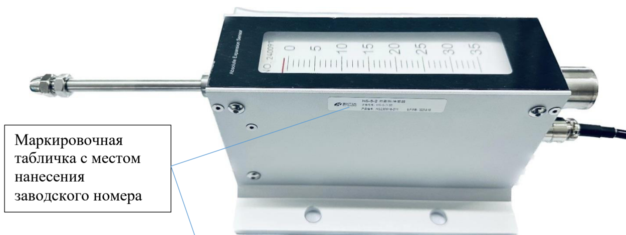
Рисунок 5 – Общий вид датчиков теплового расширения HS-5-2 из состава установки и места нанесения заводского номера
