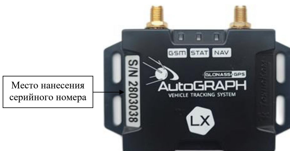
Рисунок 3 – Общий вид контроллеров модификации АвтоГРАФ-LX, исполнение АвтоГРАФ-LX (Е) (лицевая сторона)
