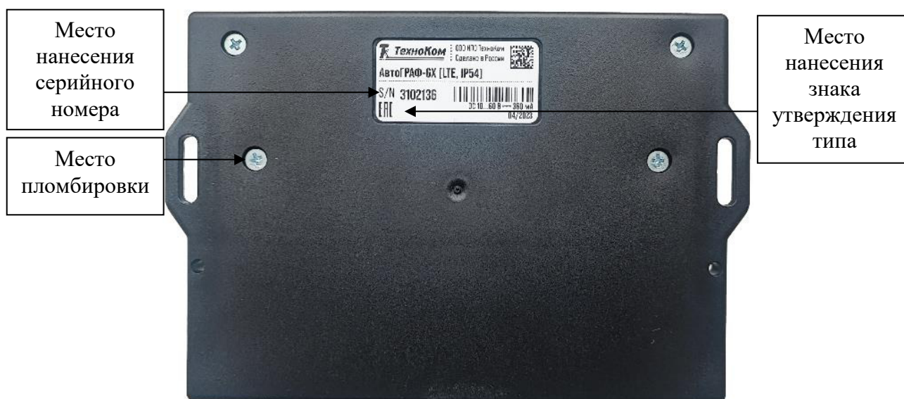
Рисунок 12 – Общий вид контроллеров модификации АвтоГРАФ-GX, исполнения: АвтоГРАФ-GX [IP54], АвтоГРАФ-GX [IP54, АКБ], АвтоГРАФ-GX [LTE, IP54], АвтоГРАФ-GX [LTE, IP54, АКБ], АвтоГРАФ-GX Wi-Fi [IP54], АвтоГРАФ-GX Wi-Fi [IP54, АКБ] (тыльная сторона)
