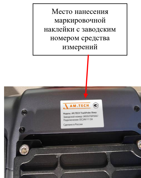
Рисунок 1 – Оптическая система слежения модификации AM.TECH TrackProbe P: а) общий вид; б) место нанесения заводского номера
