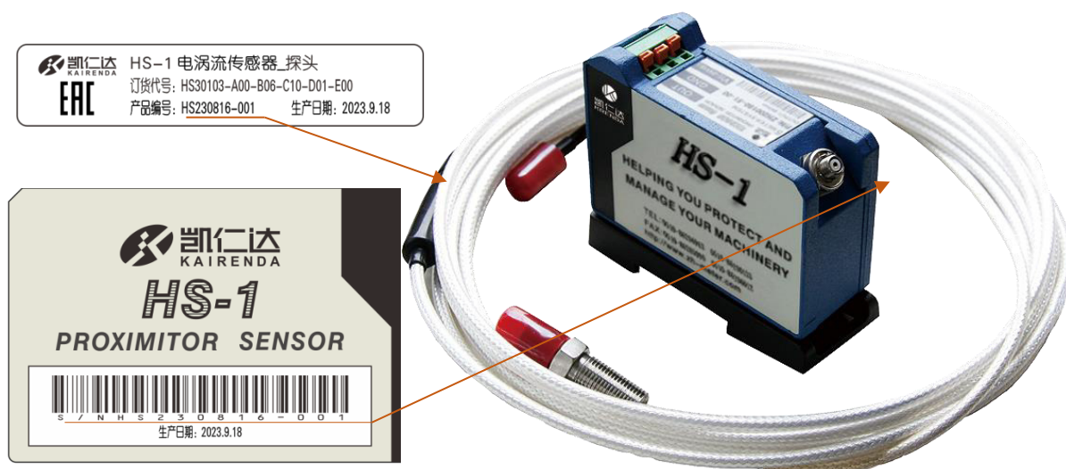
Рисунок 3 – Общий вид преобразователей вихрековых HS-1 из состава установки и места нанесения заводского номера
