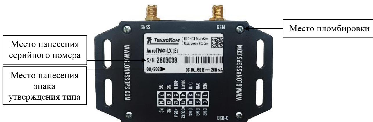
Рисунок 4 – Общий вид контроллеров модификации АвтоГРАФ-LX, исполнение АвтоГРАФ-LX (Е) (тыльная сторона)
