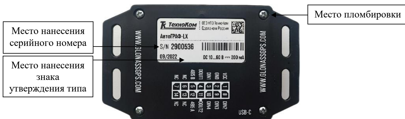
Рисунок 2 – Общий вид контроллеров модификации АвтоГРАФ-LX, исполнение АвтоГРАФ-LX (тыльная сторона)
