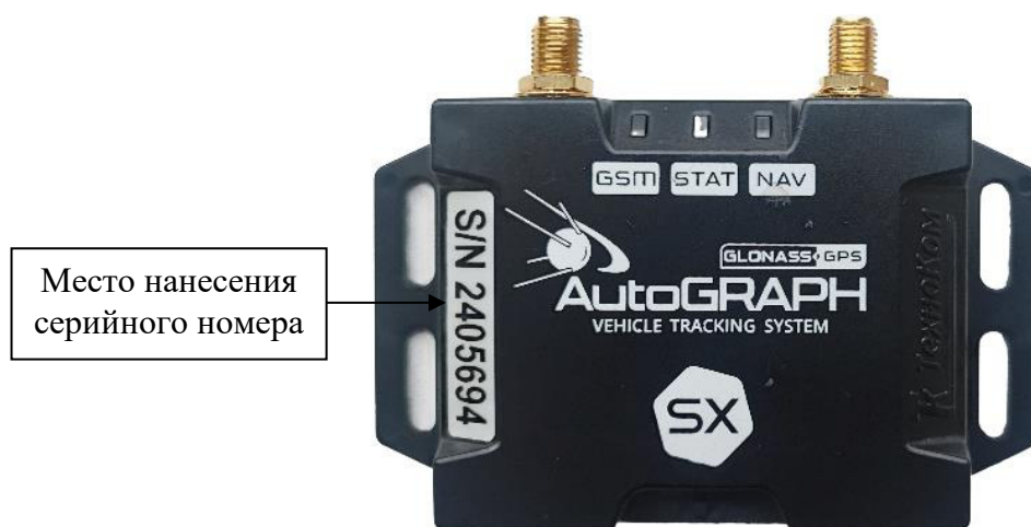
Рисунок 5 – Общий вид контроллеров модификации АвтоГРАФ-SX (лицевая сторона)
