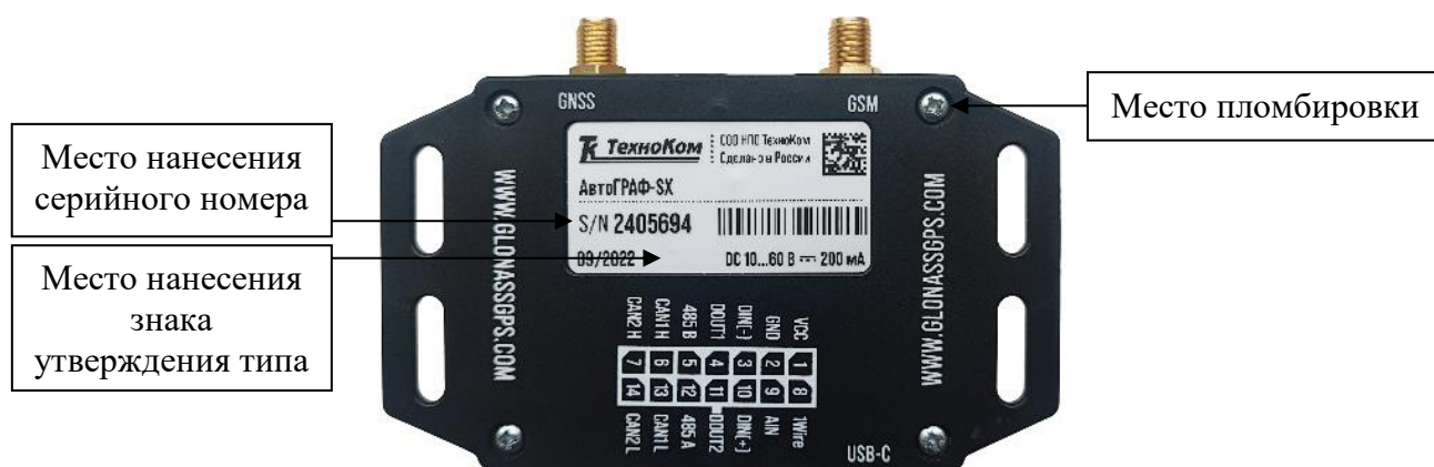
Рисунок 6 – Общий вид контроллеров модификации АвтоГРАФ-SX (тыльная сторона)
