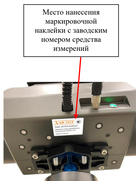
Рисунок 1 – Оптическая система слежения модификации AM.TECH TrackProbe P: а) общий вид; б) место нанесения заводского номера
