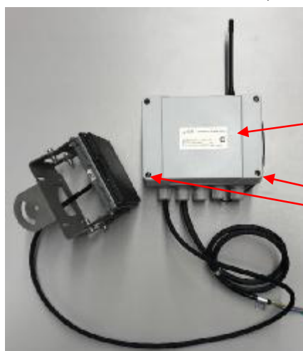
Внешний радарный детектор с коробкой коммутации для моноблока с индексом «СР»
