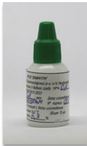
Рисунок 1 – Общий вид мер размеров частиц в водной среде МРЧ-0,2
