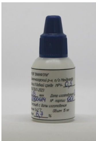
Рисунок 1 – Общий вид мер размеров частиц в водной среде МРЧ-0,5
