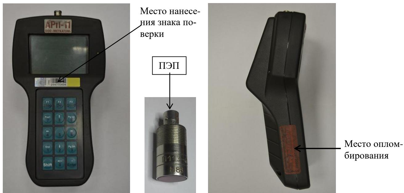
Рисунок 1 - Внешний вид измерителя АРП-11/1
