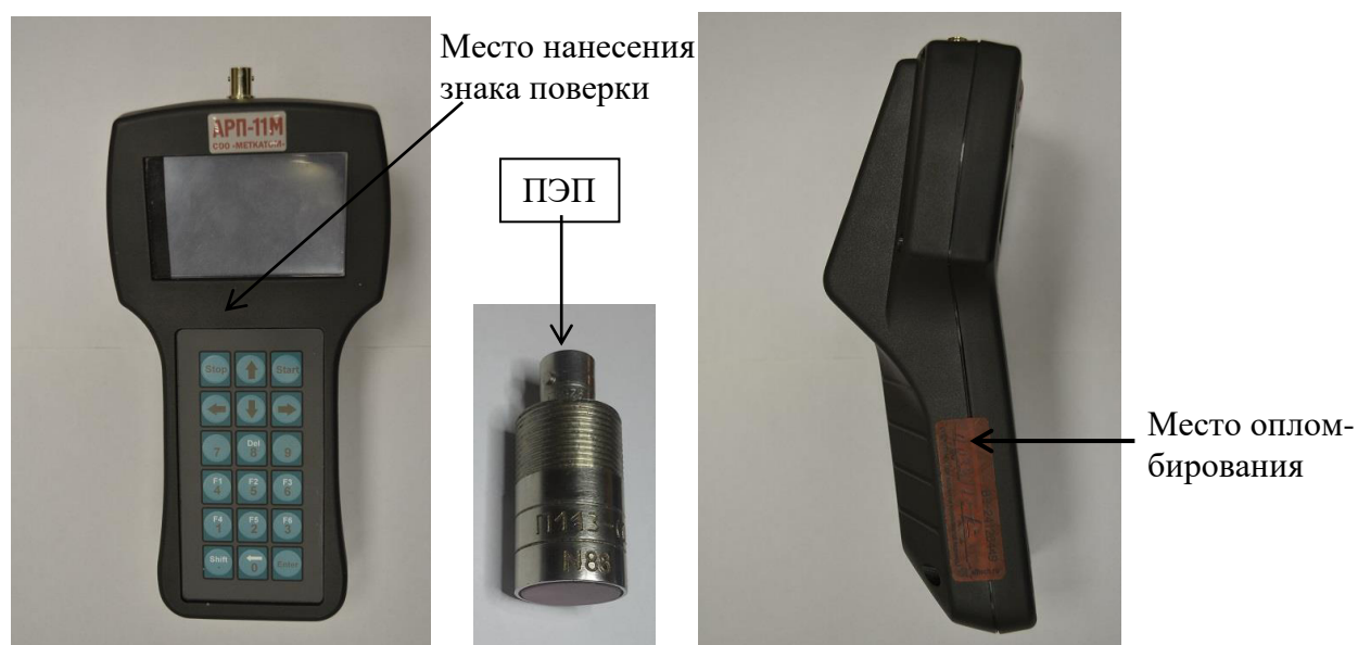
Рисунок 2 - Внешний вид измерителя АРП-11/М
