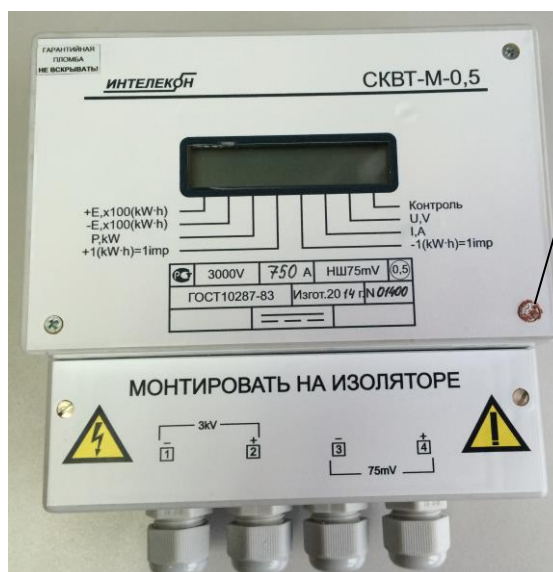
Рисунок 1 - Общий вид счетчика электрического постоянного тока СКБТ-М-0,5, схема пломбировки от несанкционированного доступа, обозначение места нанесения знака поверки
