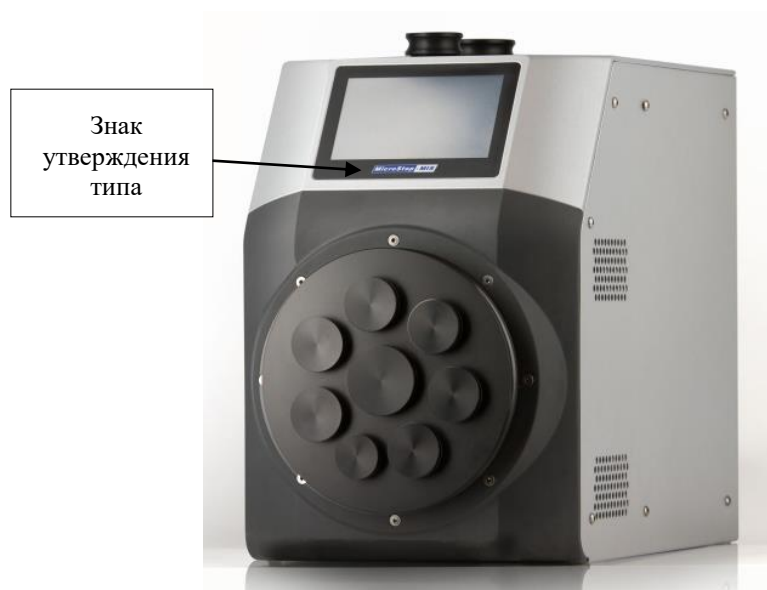
Рисунок 1- Внешний вид генератора влажного газа Humiwell, модификации Humiwell. Внешний вид контрольных гигрометров, входящих в комплект модификаций Humiwell-473, Humiwell-S8000 и Humiwell-2201 приведен на рисунке 2.
