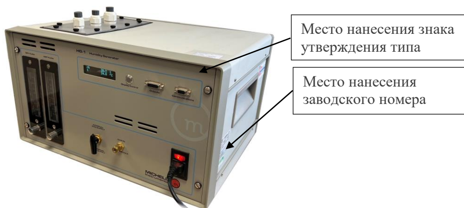
Рисунок 1 - Внешний вид генератора модификации HG-1 с указанием мест нанесения знака утверждения типа и заводского номера
