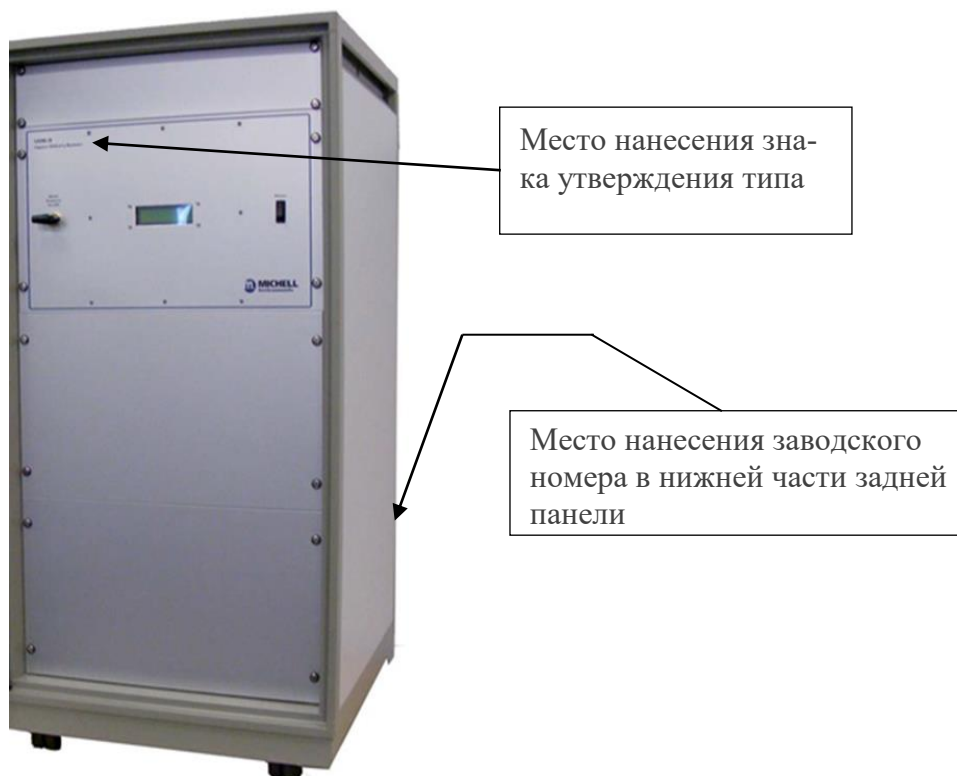
Рисунок 4 - Внешний вид генератора модификации VDS-3 с указанием мест нанесения знака утверждения типа и заводского номера
