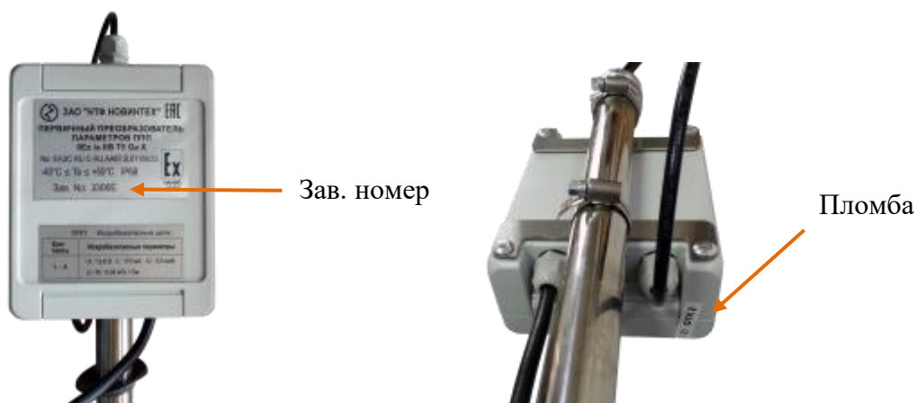
Рисунок 15 – Внешний вид ППП (контроллер без клеммного отсека)
