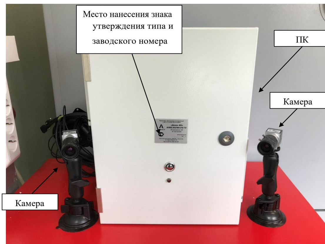
Рисунок 4 – Общий вид комплексов исполнения 03 и обозначение места нанесения знака утверждения типа и заводского номера
