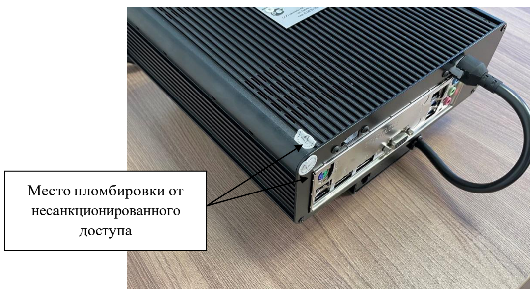
Рисунок 2 – Схема пломбировки комплексов исполнения 01 от несанкционированного доступа
