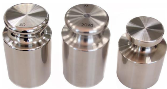
Рисунок 2 – Общий вид гирь 20 кг цилиндрических с головкой
