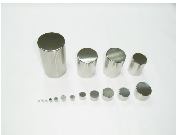
Рисунок 1 – Общий вид гирь 1 г – 10 кг цилиндрической формы без головки и с головкой
