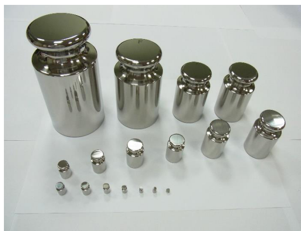
Рисунок 1 – Общий вид гирь 1 г – 10 кг цилиндрической формы без головки и с головкой
