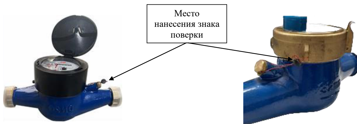
Рисунок 3 – Схема пломбировки счётчиков и место нанесения знака поверки на корпус средства измерений
