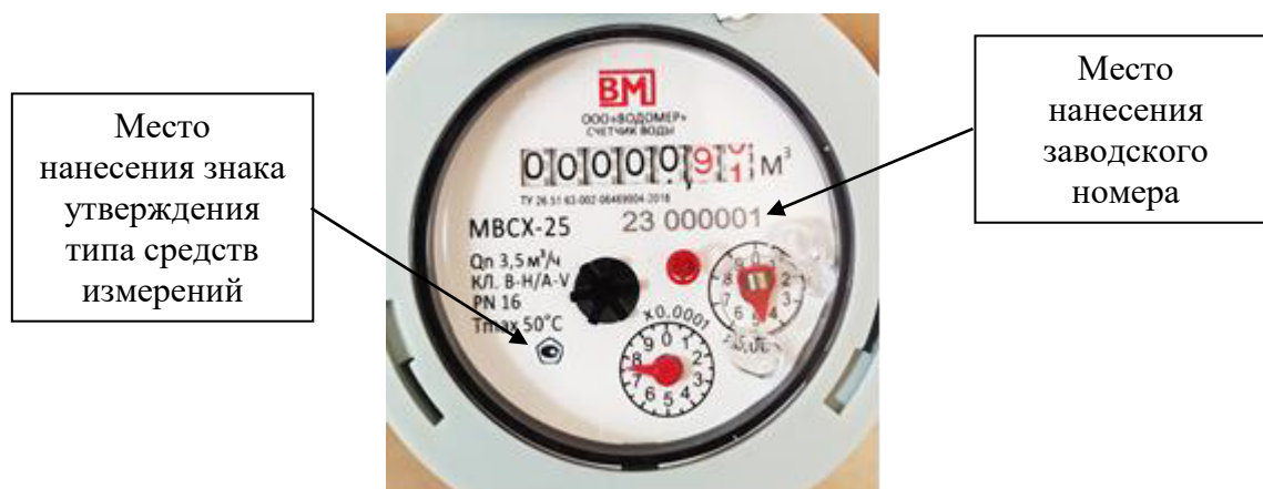
Рисунок 5 – Места нанесения заводского номера и знака утверждения типа средств измерений у счётчиков исполнения МВС-01
