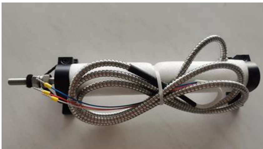
Рисунок 7 - Общий вид преобразователя перемещения HTD
