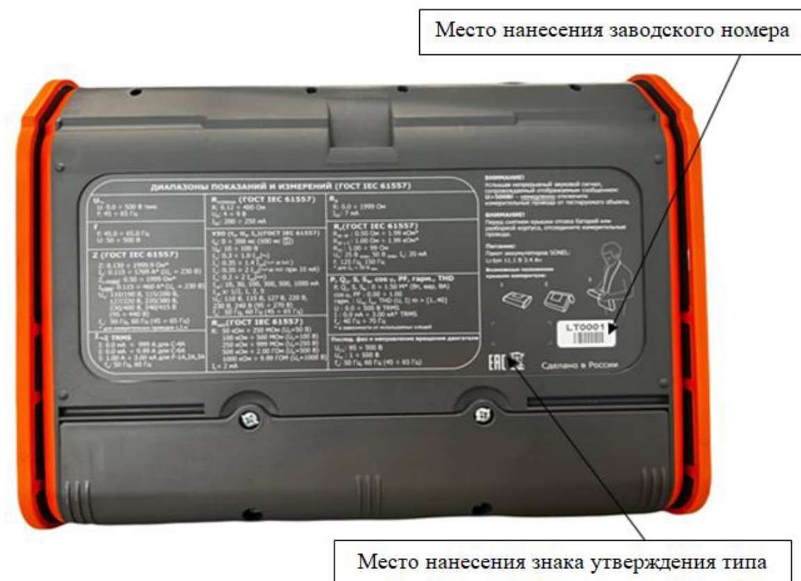
Рисунок 2 - Место нанесения знака утверждения типа и заводского номера параметров электробезопасности электроустановок ТММ
