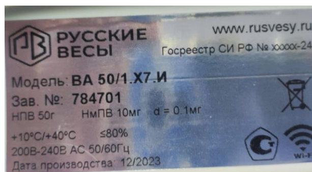
Рисунок 2 – Маркировочная табличка анализаторов влажности ВА
