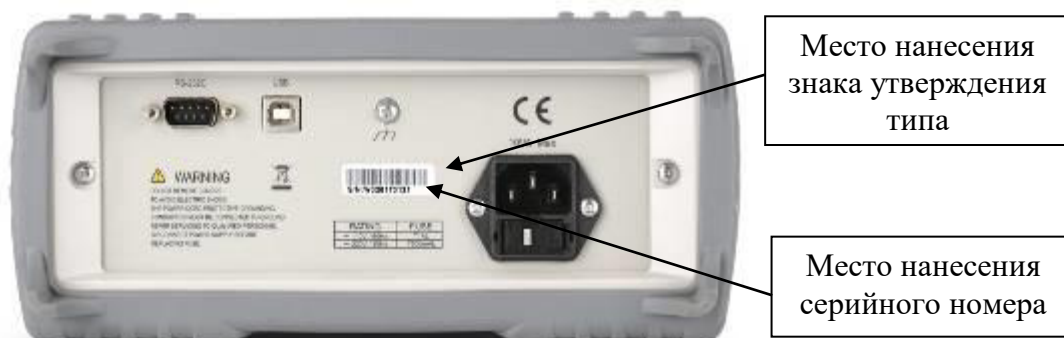
д) задняя панель мультиметров модификаций TH1952, TH1942, TH1941
