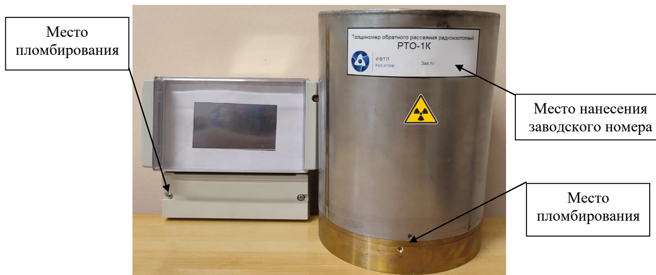
Рисунок 1 – Общий вид толщиномеров, место нанесения заводского номера и места пломбирования
