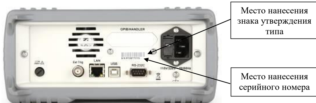
г) задняя панель мультиметров модификаций TH1953, TH1963A
