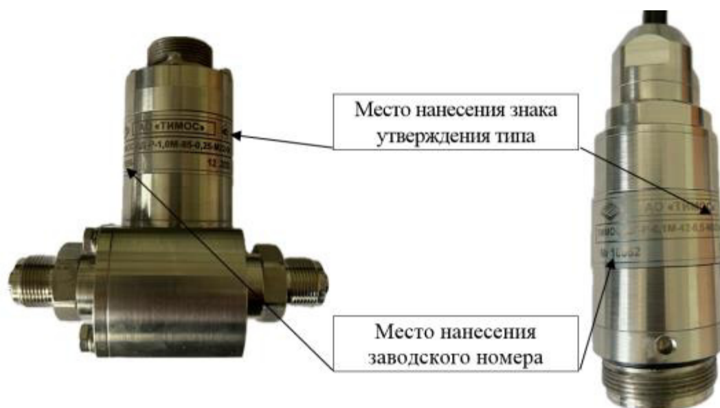
Рисунок 4 – Общий вид преобразователей давления ТИМОС, модификации ТИМОС-ДД-Р
