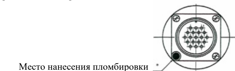
Рисунок 1 – Место нанесения пломбы преобразователей давления ТИМОС
