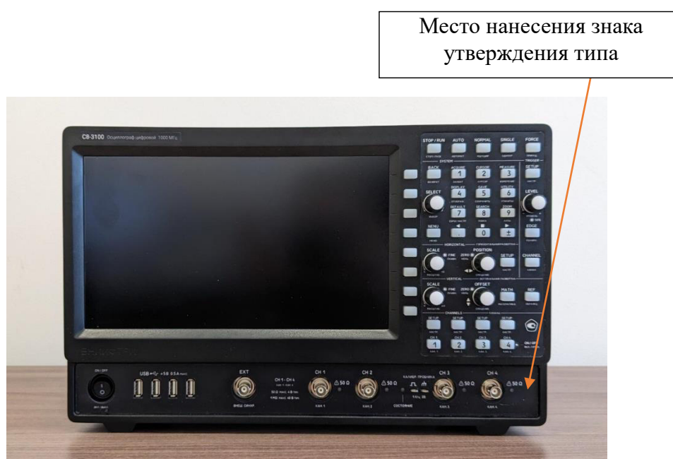
Рисунок 1 – Общий вид осциллографов с местом нанесения знака утверждения типа
