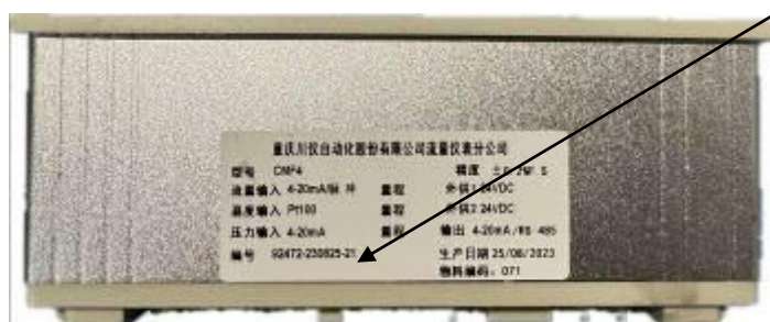
Рисунок 2 – Место нанесения серийного номера
