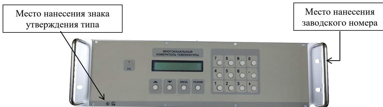
Рисунок 2 – Место нанесения заводского номера и знака утверждения типа
