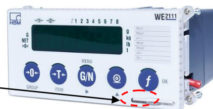
Рисунок 8 — Схема пломбировки приборов весоизмерительных CI-600D (свинцовой пломбой) - слева, WE2111 (с помощью разрушаемой наклейки) – справа
