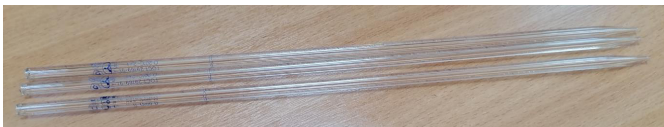
Рисунок 1 – Общий вид пипеток с одной отметкой (Мора) исполнение 1
