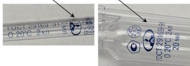
Рисунок 4 – Место нанесения знака утверждения типа и знака поверки на пипетку
