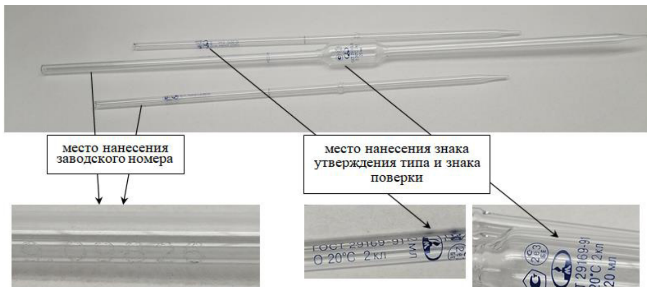
Рисунок 3 – Место нанесения заводского номера на пипетку
