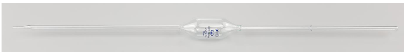
Рисунок 2 – Общий вид пипеток с одной отметкой (Мора) исполнение 2
