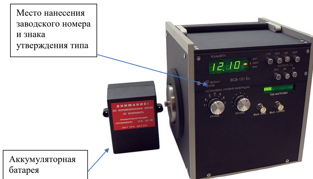
Рисунок 2 - Вид задней панели вибростенда переносного исполнения ВСВ-131
