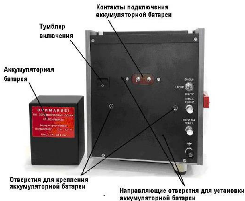
Рисунок 4 - Вид задней панели вибростенда переносного исполнения ВСВ-131 Ех и съемной аккумуляторной батареи
