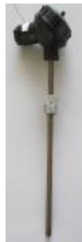
Рисунок 2 – ПИП в составе ИК объемного расхода (объема)
