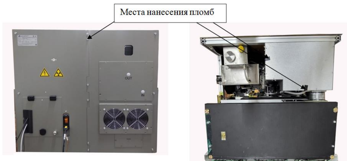
Рисунок 2а – Места пломбирования дифрактометра рентгеновского Колибри. Место установки пломб (чашка с пластином).
