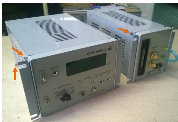
Рисунок 2 - Газоанализатор ФЛЮОРИТ-Ц. Блок измерения. Датчик. Схема пломбирования от несанкционированного доступа
