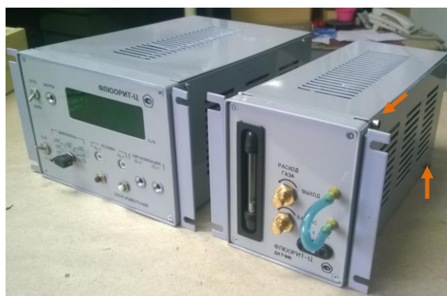
Рисунок 2 - Газоанализатор ФЛЮОРИТ-Ц. Блок измерения. Датчик. Схема пломбирования от несанкционированного доступа
