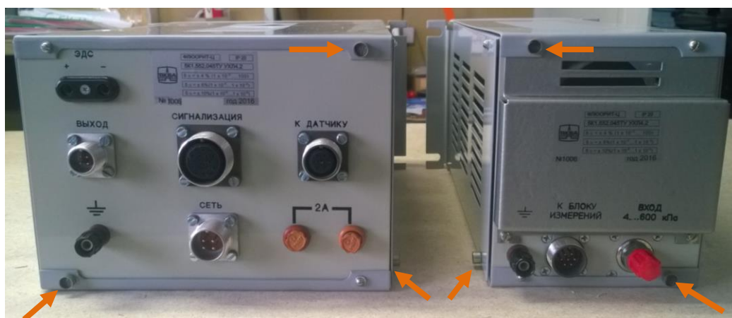
Рисунок 1 - Газоанализатор ФЛЮОРИТ-Ц. Блок измерения. Датчик. Схема пломбирования от несанкционированного доступа
