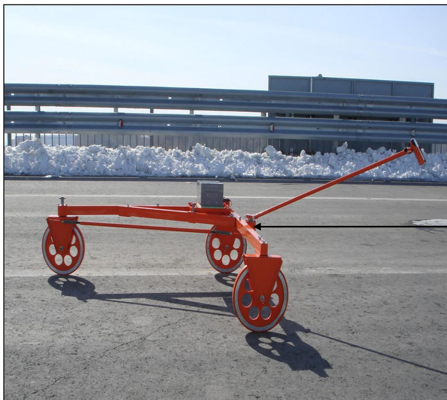
Рисунок 1 – Курвиметр дорожный УДК «РОВНОСТЬ»
