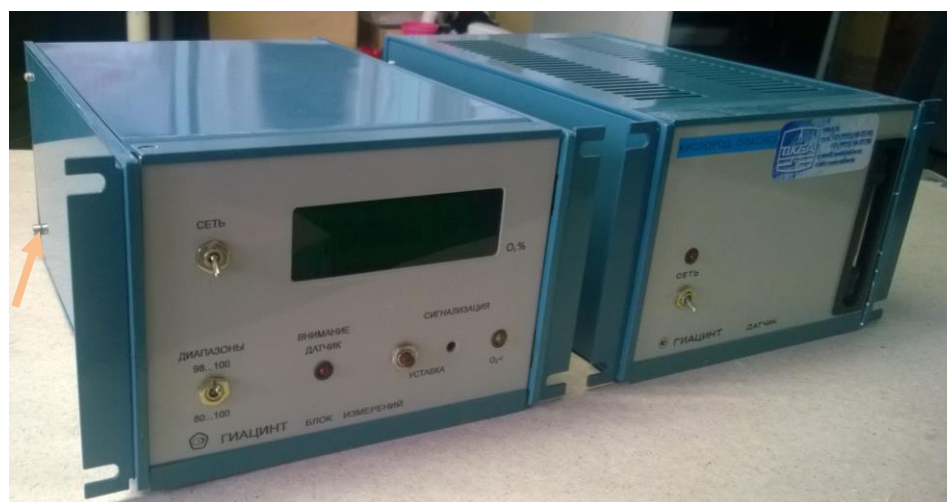
Рисунок 3 - Газоанализатор ГИАЦИНТ. Блок измерения. Датчик. Схема пломбирования от несанкционированного доступа
