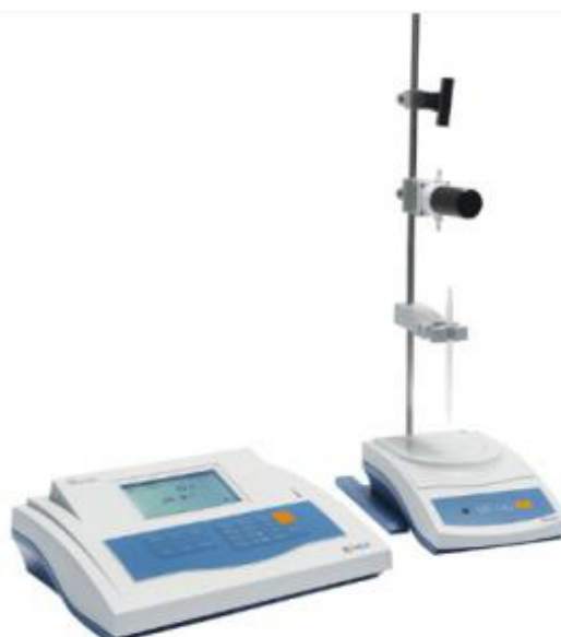
Рисунок 5 – Общий вид титраторов модификаций AT20
