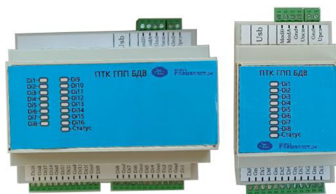
Рисунок 3 – Внешний вид блока БДВ, 16 и 8-канального
