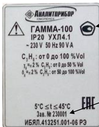
Рисунок 2 – Фирменный шильд газоанализатора ГАММА-100, зав. № 230001
