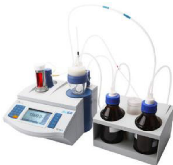
Рисунок 3 – Общий вид титраторов модификаций VKF / VCKF
