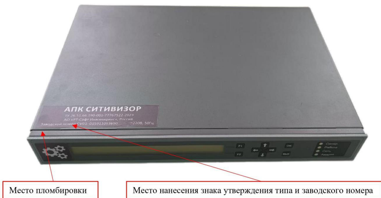
Рисунок 2 – Внешний вид сервера точного времени
