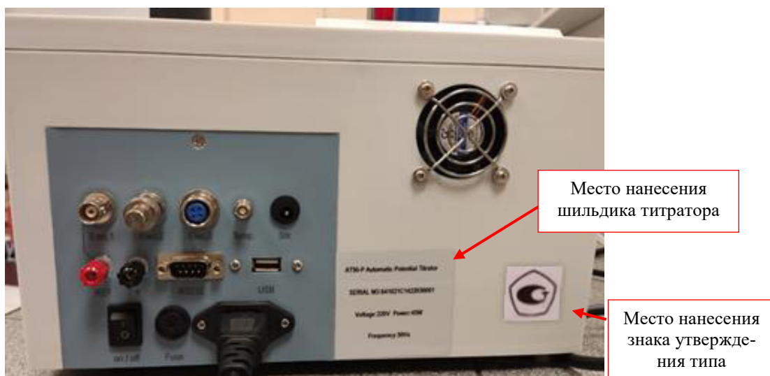
Рисунок 6 – Общий вид титратора модификации AT50-P, вид сзади
