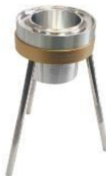
б) расположение вискозиметра B3-FORD в штативе-треноге
