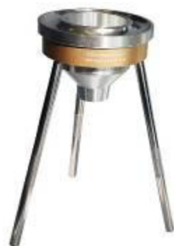
б) расположение вискозиметра B3-DIN в штативе-треноге
