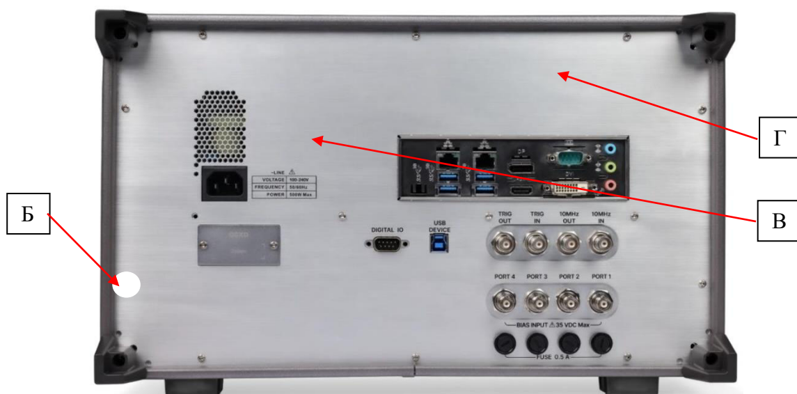
Рисунок 2 – Схема пломбировки от несанкционированного доступа (Б), место нанесения заводского номера (В) и место нанесения знака поверки (Г).
