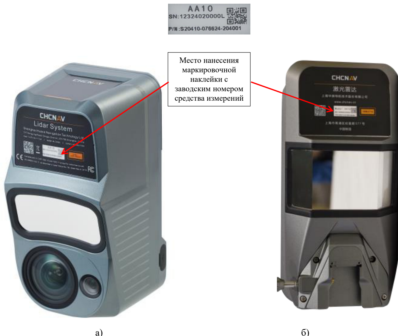
Рисунок 1 – Общий вид систем воздушного сканирования AlphaAir модификаций: а) AlphaAir 10; б) AlphaAir 15
