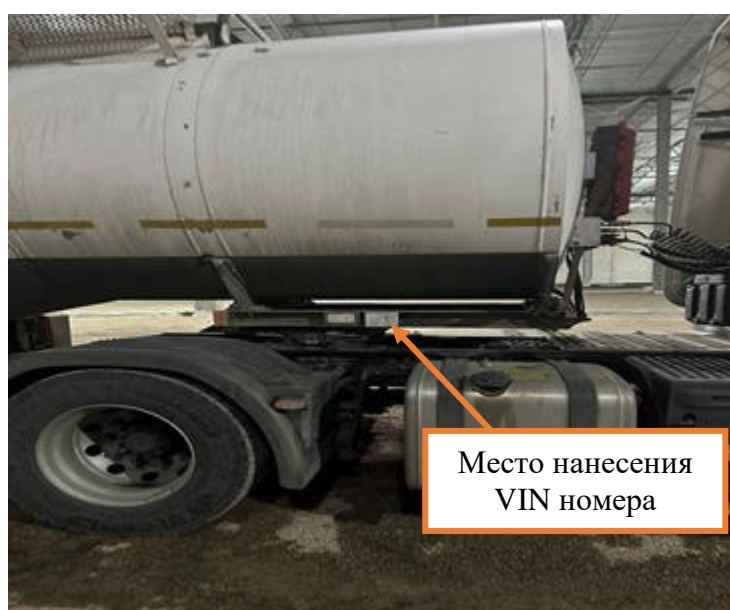
Рисунок 2 – Место нанесения VIN номера полуприцеп-цистерны STOKOTA ELZAM 3NC38
