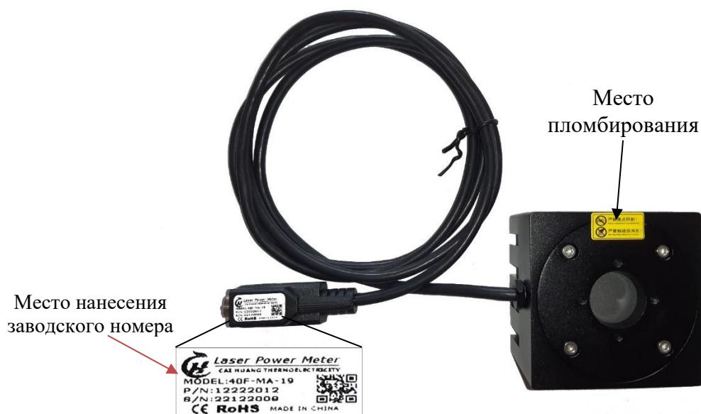
Рисунок 2 – Схема пломбировки от несанкционированного доступа, обозначения мест нанесения маркировок
