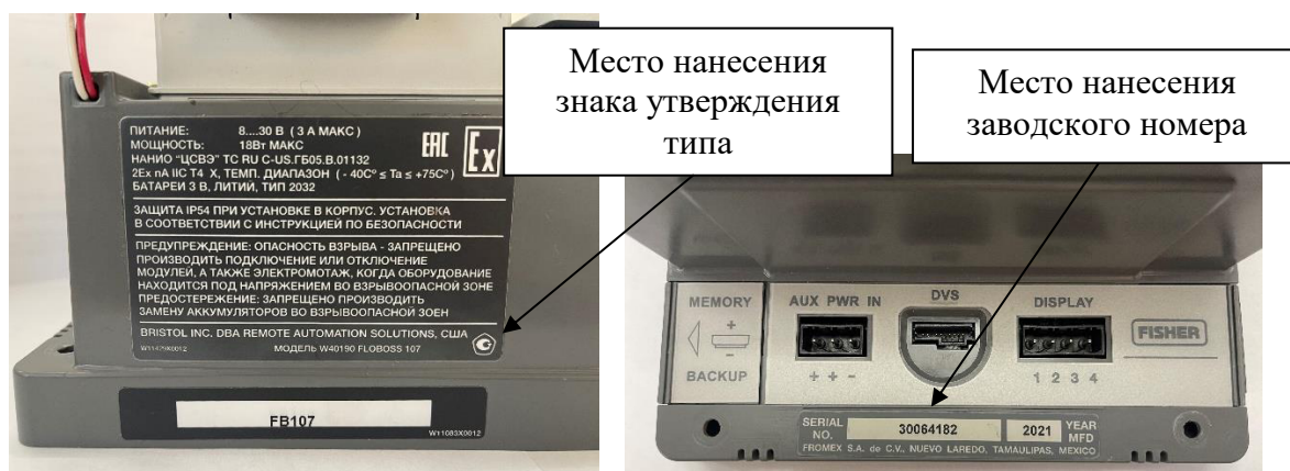
Рисунок 2 – Место нанесения знака утверждения типа и заводского номера
