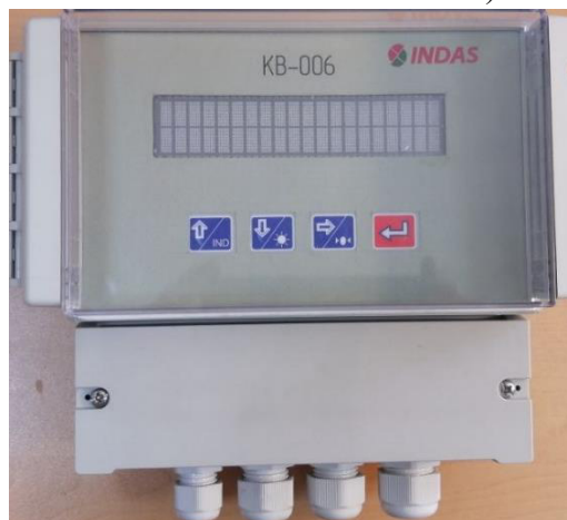
а) Общий вид весов, б) Внешний вид контроллера KB-006, в) шкаф весового прибора со встроенным преобразователем MB-110
