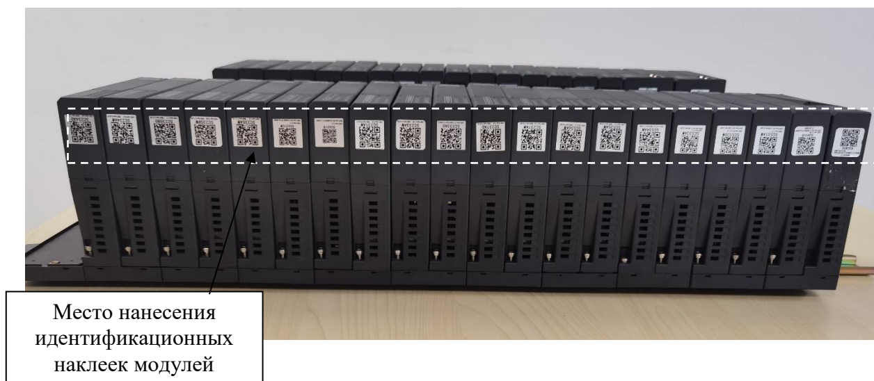
Рисунок 3 – Вид контроллеров сверху. Идентификация функциональных модулей
