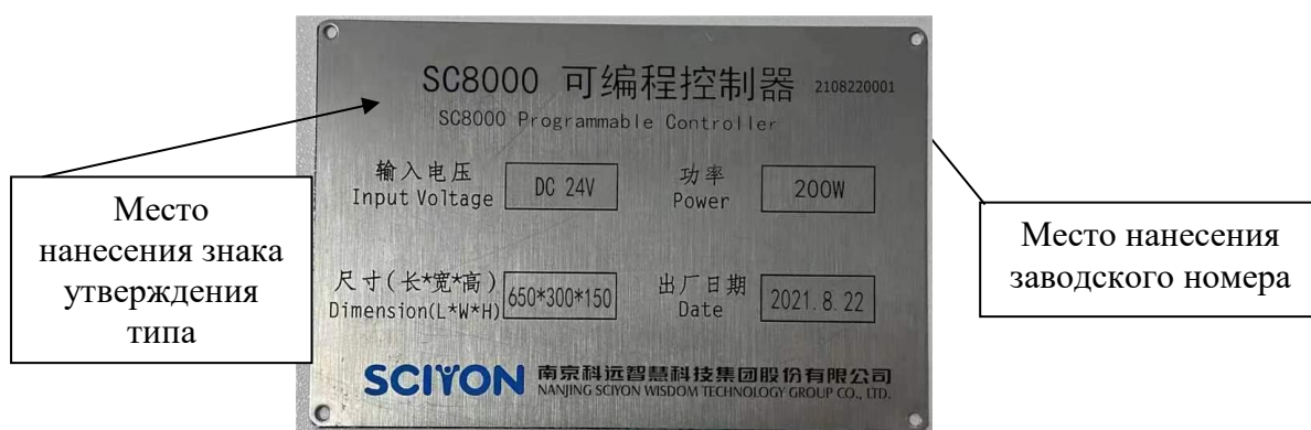
Рисунок 2 – Маркировочная табличка контроллеров
