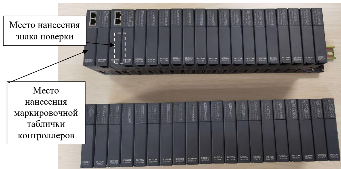
Рисунок 1 – Общий вид контроллеров
