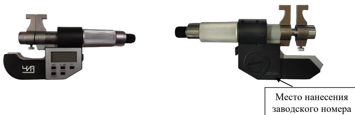
Рисунок 9 – Общий вид нутромеров модели НМБЦ с указанием места нанесения заводского номера
