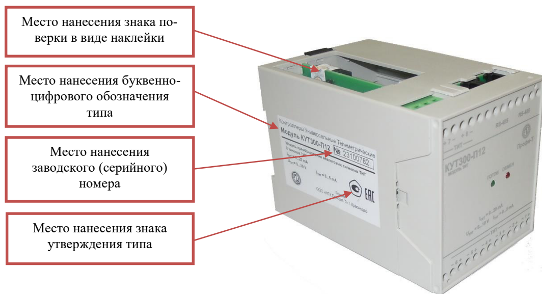
Рисунок 2 - Фотография общего вида с указанием мест нанесения заводского (серийного) номера, буквенно-цифрового обозначения типа, однозначно идентифицирующих каждый модуль КУТ300-П12, входящий в состав промышленного контроллера КУТ300-ПК, знака утверждения типа и знака поверки в виде наклейки для исключения доступа к разъёму программирования модуля
