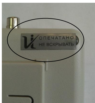
Рисунок 2 – Место пломбирования на задней панели корпуса (обведено)
