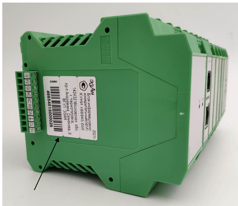
Рисунок 2 - Обозначение места нанесения знаков поверки и утверждения типа на модули из состава БИИ
