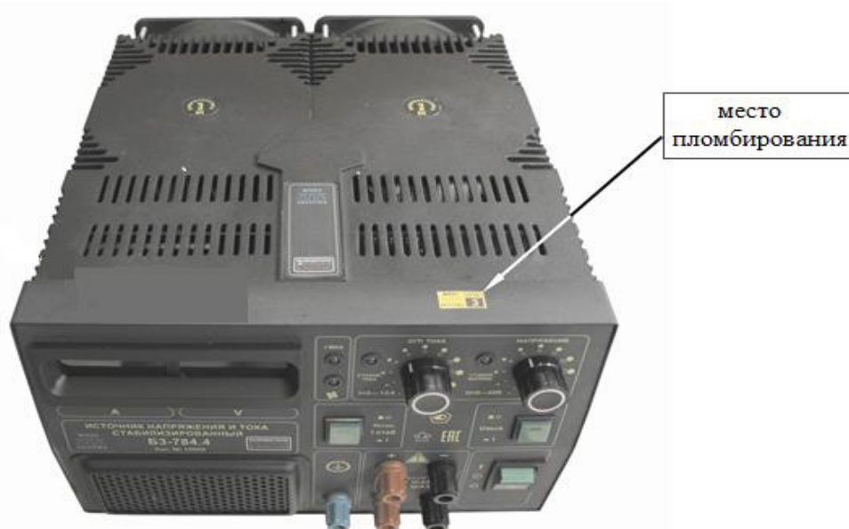
Рисунок 4 - Схема пломбировки источника для защиты от несанкционированного доступа
