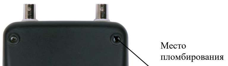
Рисунок 3 - Место нанесения пломбировки от несанкционированного доступа на панели прибора
