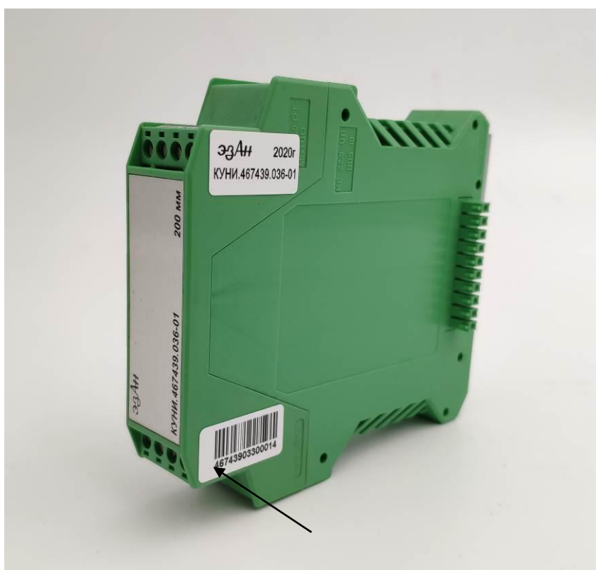
Рисунок 3 - Обозначение места нанесения заводского номера на модули из состава БИИ
