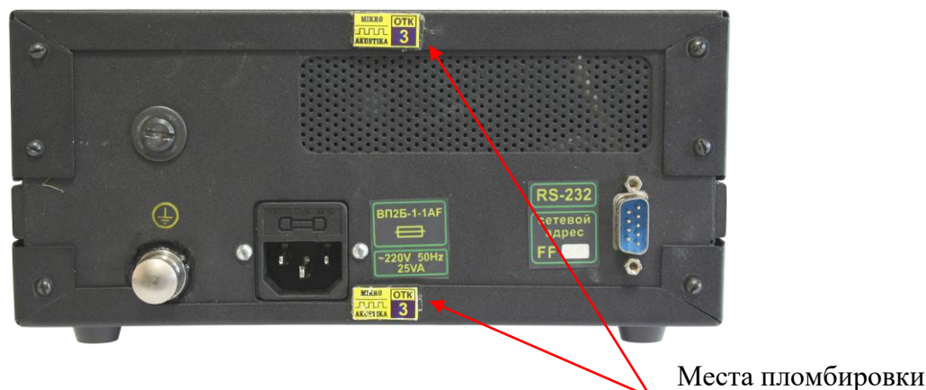
Рисунок 2 - Схема пломбировки от несанкционированного доступа
