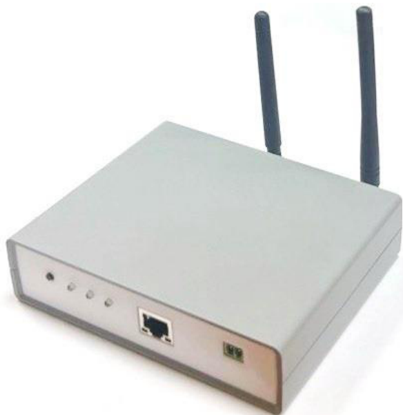
Рисунок 3 – Общий вид базовой станции
