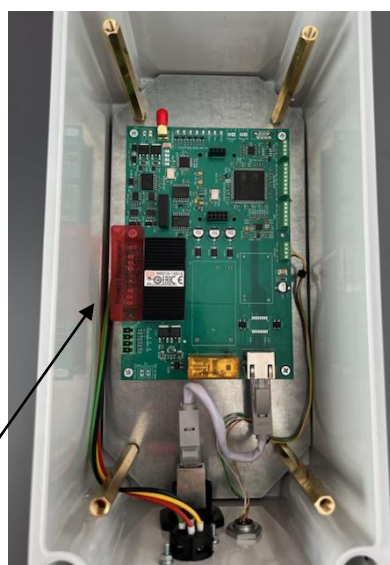
Рисунок 4 – Схема пломбировки от несанкционированного доступа расходомера-счетчика ультразвукового «NONIUS FM» без с ЖК дисплеем и кнопками
