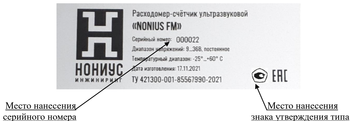
Рисунок 5 – Места нанесения знака утверждения типа и серийного номера у исполнения без кнопок и ЖК дисплея
