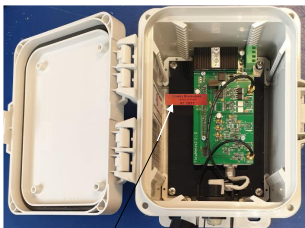
Место пломбировки от несанкционированного доступа
