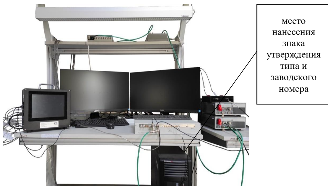
Рисунок 1 - общий вид установки
