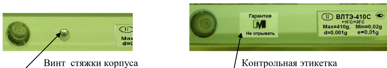
Рисунок 2 - Схема пломбирования от несанкционированного доступа
