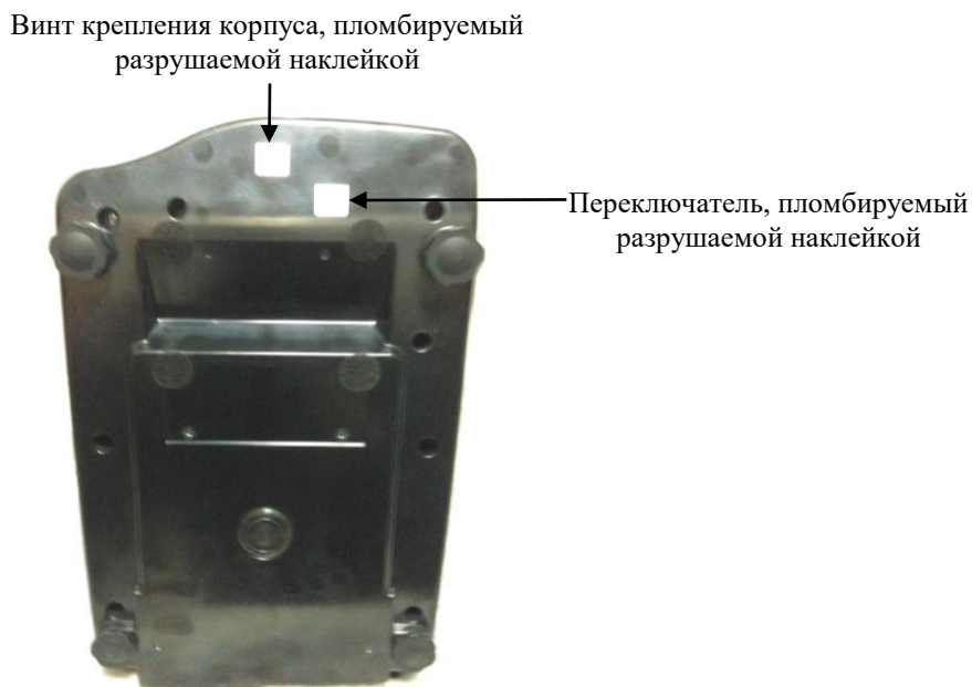
Рисунок 2 - Схема пломбировки весов от несанкционированного доступа.
